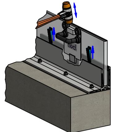
6. Zahnkeile zwischen den Glasmontagesystemen ADJUST einsetzen und durch einschlagen aufspreizen
