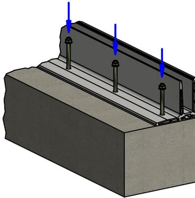
1. Basisprofil am Baukörper befestigen
