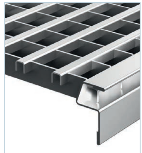
Designrost Längsprofil, Edelstahl oder Stahl verzinkt, begehbar bis 1,5 kN
