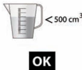
Müssen innerhalb von 10 Minuten weniger als 500 cm<sup>3</sup> Wasser nachgefüllt werden, gilt die Dichtheitsprüfung als bestanden. Prüfrichter entfernen, Prüfschrauben wieder einsetzen, Notverschluss öffnen.
