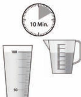
Wasserstand für 10 Minuten beobachten. Falls Füllspiegel sinkt, Klarwasser nachfüllen bis wieder eine Wassersäule von 100 mm erreicht wird. Nachgefüllte Wassermenge notieren.
