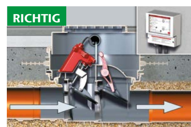
Geöffnete Klappen bei einem Fäkalien-Rückstauautomaten
