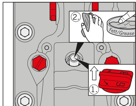
**ACHTUNG** Elektromotor vorsichtig auf die Spindel setzen (Spindel in Aufnahme führen) und spannungsfrei verschrauben. Sitz des grünen O-Rings auf der Unterseite des Elektromotors kontrollieren.
