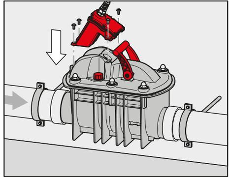
**ACHTUNG** Motorkabel und Sensorkabel spannungsfrei, ohne Knicke oder Quetschungen zum Steuergerät verlegen. Der Biegeradius des Sensorkabels muss mindestens 75 mm betragen. Veränderungen an den Kabeln und Steckern sind nicht zulässig. Sind längere Kabel erforderlich, ist ausschließlich das ACO Kabelverlängerungsset zu verwenden.
