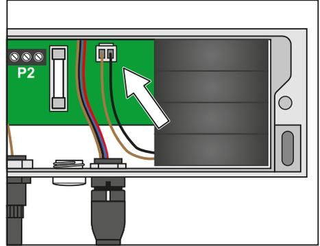
**ACHTUNG** Nur Sicherungen des gleichen Typs verwenden, Kap. 7 „Technische Daten“.
