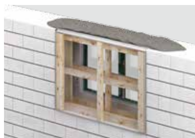
2. Beim Hochmauern den Zwischenraum zwischen Stein und Fenster schichtweise ausmörteln.
