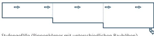
Stufengefälle (Rinnenkörper mit unterschiedlichen Bauhöhen)
