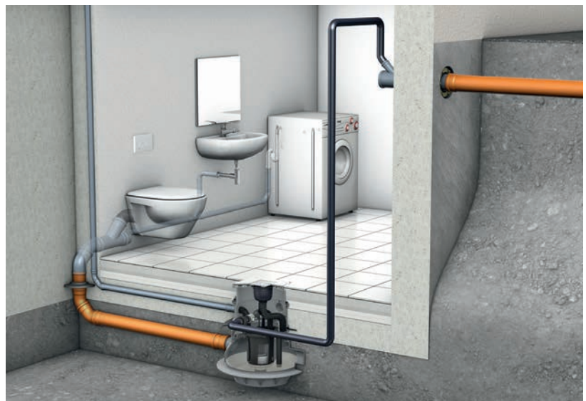
Hebeanlage – ohne natürliches Gefälle zum Kanal
