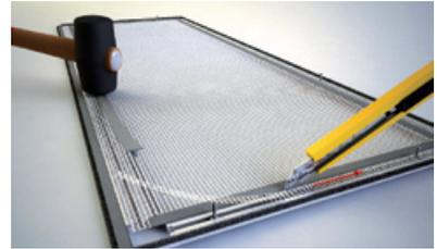
9. Richten Sie das Gewebe auf der Abdeckung aus. Fixieren Sie das Gewebe mittels des Einschlagkeders, wie im Bild dargestellt. Anschließend schneiden Sie das Gewebe rund um den Keder ab
