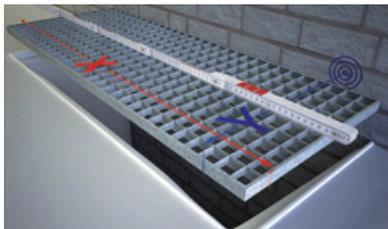
3. Ermitteln Sie die Breite des Gitterrostes (X-Maß). Ermitteln Sie die Tiefe des Gitterrostes und addieren Sie den Abstand zur Wand (Y-Maß). Achtung: Unebenheiten im Mauerwerk unbedingt berücksichtigen
