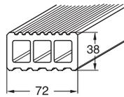
WPC Unterkonstruktionsriegel bz - 72 x 38 mm
