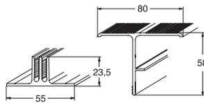
Alu-Fugen-Abdeckprofil, 2-teilig (Grund- und Deckprofil, Länge 4 m)
