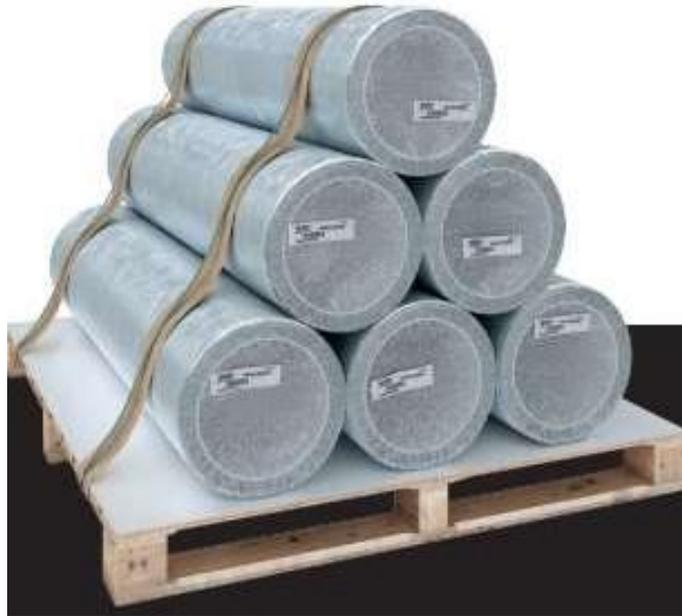
SWISS KRONO HPL BE.VELVET *antifingerprint* Schichtstoffe müssen immer in einem geschlossenen, trockenen Lagerraum bei einer Temperatur von mindestens 18 °C und höchstens 25 °C und einer Luftfeuchtigkeit von 50-60 % gelagert werden, und zwar für einen Zeitraum von maximal 6 Monaten.
