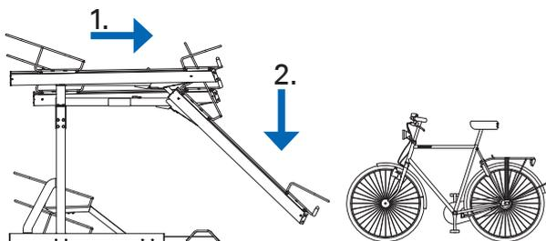
1. Fassen Sie den Griff und ziehen Sie die Schiene gerade aus.
