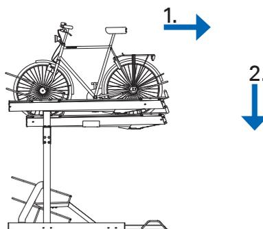
1. Ziehen Sie die Schiene mit dem Fahrrad nach hinten, bis das Fahrrad eine aufrechte Stellung erreicht hat.
