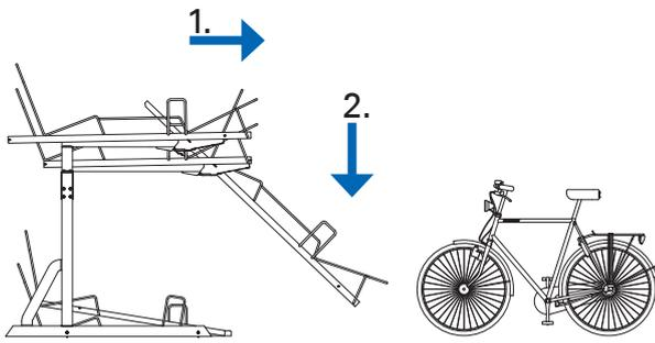
1. Fassen Sie den Griff und ziehen Sie die Schiene gerade aus.
