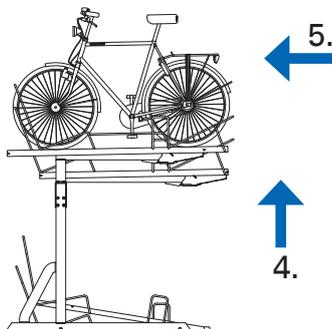
4. Heben Sie die Schiene, bis das Fahrrad eine aufrechte Stellung erreicht hat.
