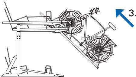
3. Heben Sie das Vorderrad des Fahrrads und stellen Sie das Vorderrad in die Schiene. Drücken Sie das Fahrrad nach oben und stellen Sie das Hinterrad in die Schiene.
