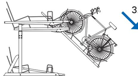
3. Heben Sie das Hinterrad von die Aussparung und rollen Sie das Rad nach unten. Stellen Sie das Fahrrad neben das Fahrradparksystem.
