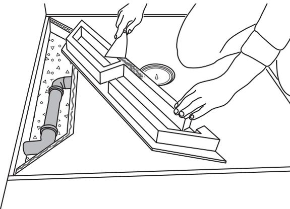
7) Anschließend wird auf der Unterseite der Rohrabdeckung Fliesenkleber aufgetragen.
