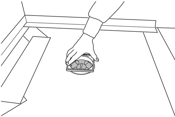
11) Je nach Fliesendicke wird das Aufsatzstück (4) auf die passende Länge gekürzt und eingesetzt. Die genaue Höheneinstellung des Aufsatzstückes (4) erfolgt durch Unterfüttern mit Fliesenkleber an den 4 Eckbereichen.
