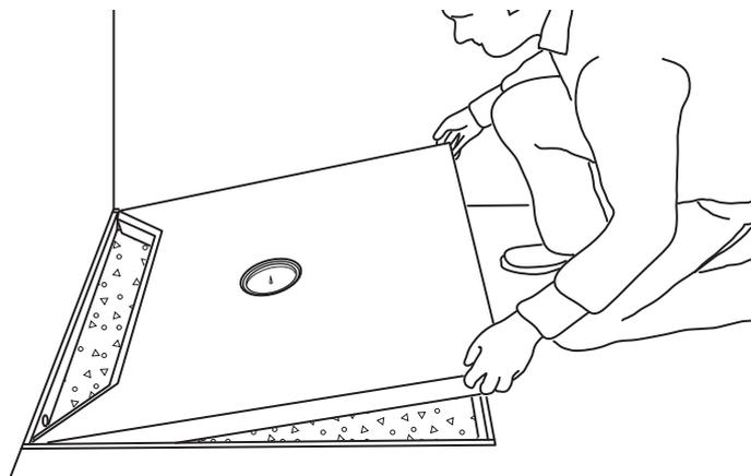
4) Die Verbindung zwischen dem Ablaufstutzen des Duschelementes (DN40) und dem bauseits vorhandenen Abflussrohr wird hergestellt.
