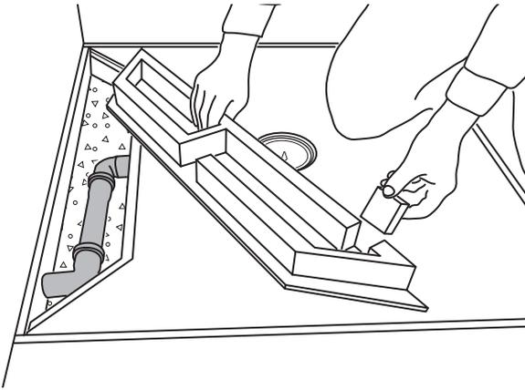
5) Auf der Unterseite der Rohrabdeckung (2) werden die Durchbrüche für das Abflussrohr mit dem Cutter ausgeschnitten.
