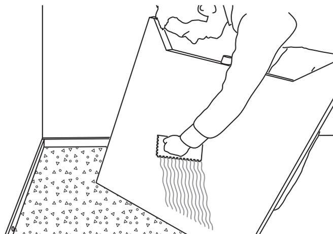
3) Das Duschelement wird in die Estrichaussparung eingesetzt.
