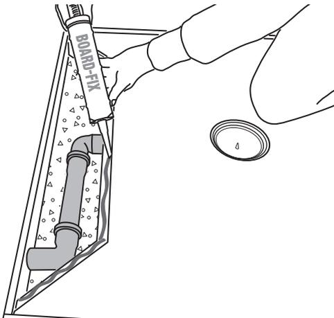
6) Der zum System gehörende Kleber BOARD-FIX® (6) wird auf den Stufenfalz des Duschelementes strangförmig aufgetragen.
