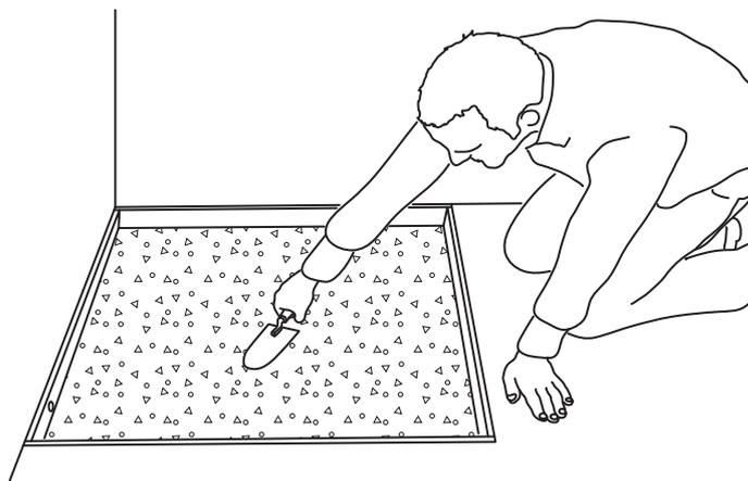
2) Auf die Unterseite des Duschelementes wird mit einem Zahnpachtel Fliesen- bzw. Flexkleber aufgetragen.
