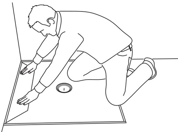
8) Die Rohrabdeckung (2) wird in die Estrichaussparung eingesetzt und fest angedrückt.
