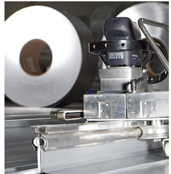
Durchdringungsfreie Montage der BEMO-AKKORD Schiene
