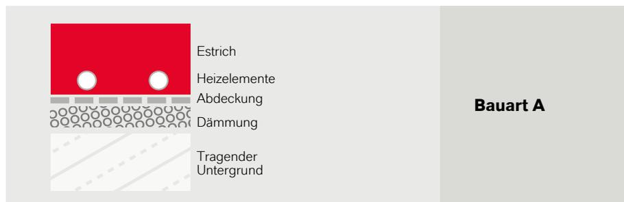
Bei Heizestrichen der Bauart A ist die jeweilige Nenndicke um den Durchmesser der Heizrohre zu erhöhen
