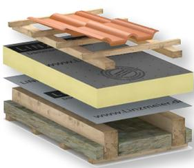
Altbausanierung mit vorhandener Zwischensparrendämmung
