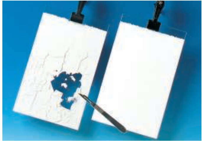
Links: Herkömmliche Dispersions-Fassadenfarbe, rechts: Amphibolin.
