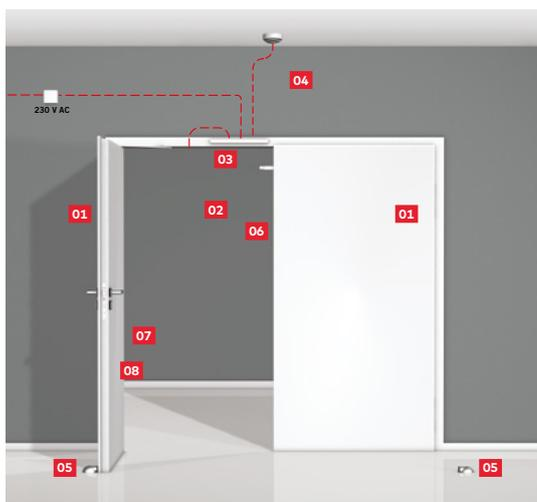
Feststellanlage an einer 2-flügeligen Tür, bestehend aus 2 Türschliessern ITS 96 **01**, Gang- und Standflügel-Gleitschiene G 96 GSR-EMF 1 **02** mit Schubstangen-Klemmsystem, Rauchmeldezentrale RMZ **03** als Sturzmelder sowie je 1 Rauchmelder RM-N **04** als Deckenmelder auf beiden Seiten der Tür, 2 Türstopper TZ 5000 **05**, Mitnehmerklappe MK 397 **06**, OGRO Türdrücker 8100 **07**, OGRO Rosetten im XEA Design **08**
