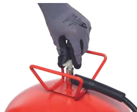
Drehen Sie das weiße Ventil des Kanisters gegen den Uhrzeigersinn, bis es geöffnet ist. Schließen Sie das Ventil nicht eher, bis der Kanister leer ist (dies ist um ein Eintrocknen des Klebers im Schlauch und Pistole zu verhindern).
