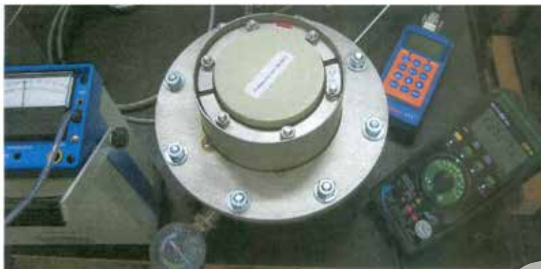
Abbildung 1: Prüfung des Dichtungssatzes Kraso Uni 150 DD/T (#1) mit Prüfbehälter des Auftraggebers (Mitte), links Lecksucher, rechts oben: Messanzeige für Drehmomentaufnahme, rechts unten Handmultimeter für Druckanzeige
