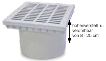
Poly 400 Schlitzrostabdeckung Kunststoff - befahrbar - A15 Rahmen und Deckel aus Kunststoff, Durchlauf ca. 4,1 l/sek., höhenverstell- und verdrehbarer Aufsatzrahmen von 8 - 25 cm, Kantenlänge 45 cm
