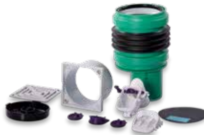
KRASO® Bodenablauf Typ FS - RS mit verschraubbarem Edelstahlrost Klasse K3, frostsicherem Rückstaudopperverschluss, 2 selbsttätigen Verschlussklappen, wovon eine zusätzlich von Hand als Notverschluss verriegelbar ist, Schlammfangsieb und Bauzeitschutzdeckel
