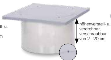
Poly 400 Abdeckung Kunststoff - tagwasser- und geruchsdicht - begehbar - Rahmen und Deckel aus Kunststoff, verschraubbar, höhenverstell- und verdrehbarer Aufsatzrahmen von 2 - 20 cm, Kantenlänge 46 cm
