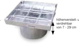
Poly 400 Abdeckung - verfüllbar - tagwasser- und geruchsdicht - befahrbar - ca. 125 kN Kantenlänge 53 cm, verzinkt, Belastung nach Verfüllung mit Beton C 35/45 : ca. 125 kN, höhenverstell- und verdrehbar von 7 - 29 cm
