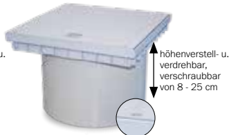
Poly 400 Abdeckung Kunststoff - befahrbar - A15 Rahmen und Deckel aus Kunststoff, höhenverstell- und verdrehbarer Aufsatzrahmen von 8 - 25 cm, Kantenlänge 45 cm
