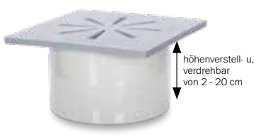
Poly 400 Schlitzrostabdeckung Kunststoff - begehbar - Rahmen und Deckel aus Kunststoff, Durchlauf ca. 3,9 l/sek., höhenverstell- und verdrehbarer Aufsatzrahmen von 2 - 20 cm, Kantenlänge 46 cm
