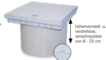
Poly 400 Abdeckung Kunststoff - tagwasser- und geruchsdicht - befahrbar - A15 Rahmen und Deckel aus Kunststoff, höhenverstell- und verdrehbarer Aufsatzrahmen von 8 - 25 cm, Kantenlänge 45 cm
