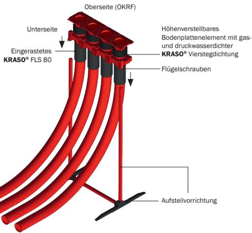
Beispiel Montageset Verdreh- u. Ausreißsicherung: Gashauseinführung Schuck DN 25
