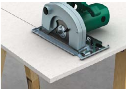
Sägen mit Handkreissäge (Drehzahl regulierbar)
