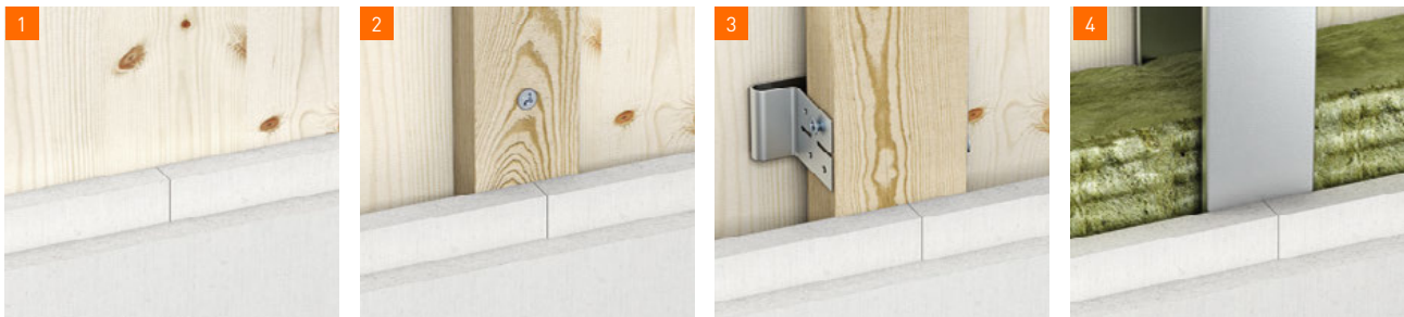
1 Direkt Beplankung auf Massivholz/ Brettsperrholz (alternativ Holzwerkstoffplatten)
