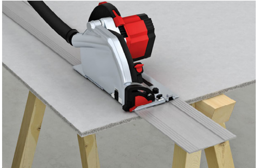
Zuschnitt der fermacell® Powerpanel H 2 O Platten mittels schienengeführter Handkreissäge
