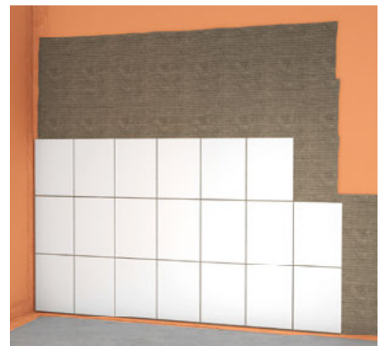
Abb. 9: Verfliesung mit fermacell™ Flexkleber im Dünnbettverfahren auf vollflächiger Abdichtung (Sicherstellung der Abdichtung für die Wassereinwirkungsklasse W2-I).
