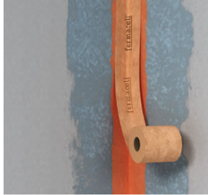
Abb. 2 + 3: fermacell™ Dichtband in die zuvor aufgetragene, noch feuchte fermacell™ Flüssigfolie drücken und direkt mit Flüssigfolie überstreichen – Trocknungszeit mind. 1 Stunde.
