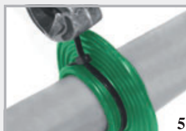
5 Die Spannbänder können auch mit der Zange angezogen werden
