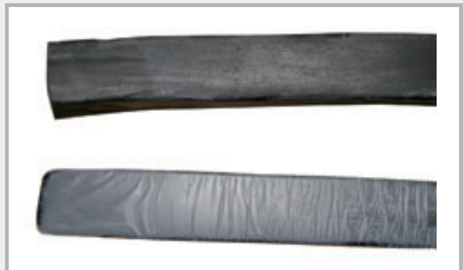
Vergleich Quellband mit und ohne Schutzhülle
