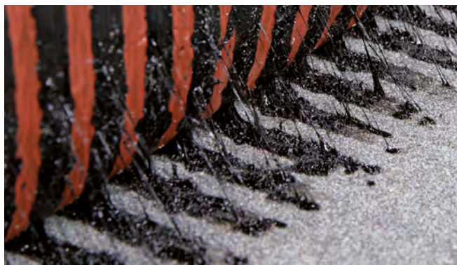
Power-THERM-Streifen mit roter SYNTAN®-Beschichtung
