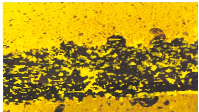
Schnitt durch eine nicht homogene Standard PYE PV-Bahn abgebildet
