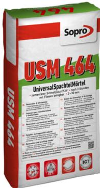
Zementärer, grauer, schnell erhärtender, standfester Universalspachtelmörtel. Zementputz nach DIN EN 998-1 (GP) der Festigkeitsklasse CS IV. Zum Glätten und Ausbessern von Wand- und Bodenflächen aus Beton, Putz, Mauerwerk und Estrichen. Insbesondere als Ausgleichsputz und Gefällespachtel in Feucht- und Nassräumen oder auf Balkonen und Terrassen einsetzbar.
