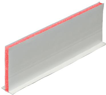
Selbstklebendes Profil aus geschlossenzelligem, unverrottbarem, zweiseitig folienkaschiertem Polyethylenschaumstoff. Zur spannungsabbauenden Begrenzung von Feldern und Ausbildung von Fugen. Einsatz in Verbindung mit Sopro Fließspachtelmassen sowie beim Einbau von Zement- und Calciumsulfatestrichen, insbesondere Sopro Rapidur® Fließestrich.
