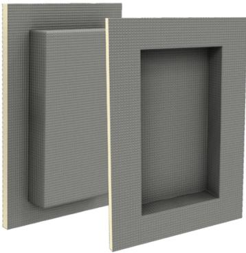
Hochwertiges Nischenelemente aus einem wasserdichten, extrudierten Polystyrol-Hartschaum (XPS) Trägerelement, beidseitig mit einer mineralischen Spezialbeschichtung. Konstruktives Element für den Innenausbau, insbesondere bei Feuchtraumanwendungen. Abdichtung im Verbund mit Fliesen- und Plattenbelägen nach DIN 18534.
