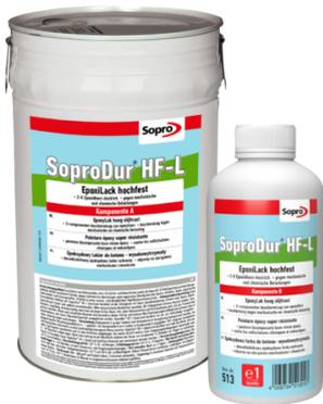
Zweikomponentige Epoxidharz-Schutzbeschichtung auf Basis eines speziellen, pigmentierten Bauharzsystems. Zum Schutz von zementgebundenen Untergründen, wie z. B. Estrich- und Betonflächen sowie mit Sopro FließSpachtel hochfest hergestellten direkt nutzbaren Flächen gegen mechanische und chemische Belastungen. Erhärtet zu einer wasserdampfundurchlässigen Oberflächenschutzschicht. Daher auch als Nachbehandlungsmaßnahme für junge Estriche geeignet.
