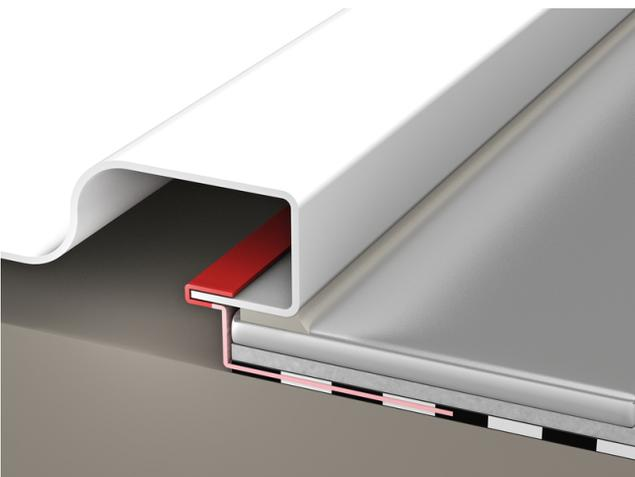
Sonderfall: Soll die Duschwanne auf dem Fliesenbelag aufliegen, so sind Bänder und Formteile unterseitig bis in die Kantung des Wannenrandes einzukleben (dabei Duschwanne für die Montage wenden).
