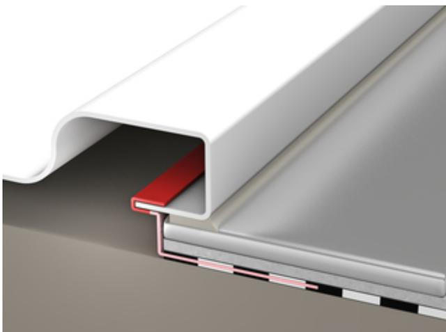
11) Sonderfall: Soll die Duschwanne auf dem Fliesenbelag aufliegen, so sind Bänder und Formteile unterseitig bis in die Kantung des Wannenrandes einzukleben (dabei Duschwanne für die Montage wenden).
