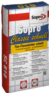
Zementärer, schnell erhärtender Flex-Fliesenkleber, C2 FT nach DIN EN 12004, mit guten Verarbeitungseigenschaften und hoher Standfestigkeit, zum Ansetzen und Verlegen von keramischen Fliesen und Platten sowie Feinsteinzeug. Geeignet auf Wand- und Fußbodenheizungen und Verbundabdichtungen.
