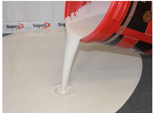
Der selbstnivellierende Sopro FS Hybrid lässt sich hervorragend ausgießen.
