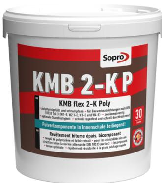
Zweikomponentige, polystyrolgefüllte, schrumpfarme, kunststoffmodifizierte Bitumen-Dickbeschichtung (PMBC) zur Herstellung von flexiblen, rissüberbrückenden Bauwerksabdichtungen gemäß DIN 18533.
