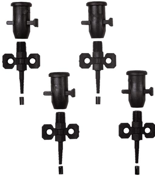
Sopro MörtelPacker: Werden in die Bohrlöcher eingedreht. Sie sind unten geöffnet und ermöglichen das Verfestigen von porösen, festigkeitsschwachen Verlegemörteln.
