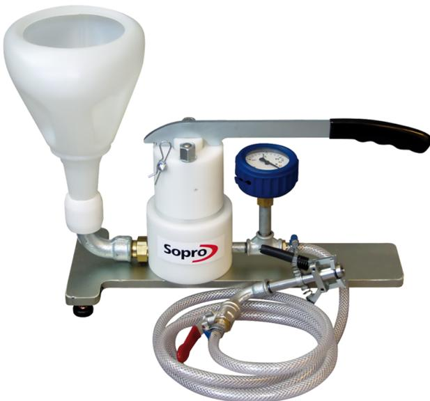
Sopro Injektionspresse: Zum Verpressen von Soprodur®-MicroHohlraumSchlämme empfohlen. Durch das Niederdruckverfahren wird Soprodur®-MicroHohlraumSchlämme in alle Hohlräume unter Fliesen- und Natursteinbelägen und in poröse Verlegemörtel gepresst. Ebenfalls lieferbar ist ein entsprechendes Verschleißteil-Set (Best.-Nr. 908).
