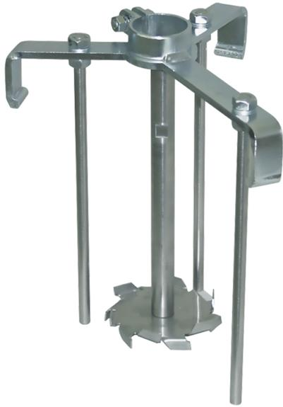
Sopro Profi-Anmischvorrichtung: Zum Anmischen von 2 – 6 kg Soprodur®-MicroHohlraumSchlämme. Mit Fixierkralle zum Aufsetzen auf den Soprodur®-Eimer. Mit Spezial-Mischscheibe (Dissolverscheibe). Benötigt wird eine Bohrmaschine 1/2 Zoll, 20 UNF, mit Spindelhalbs 43 mm Europeanorm, Mindestdrehzahl > 2000 U/min.
