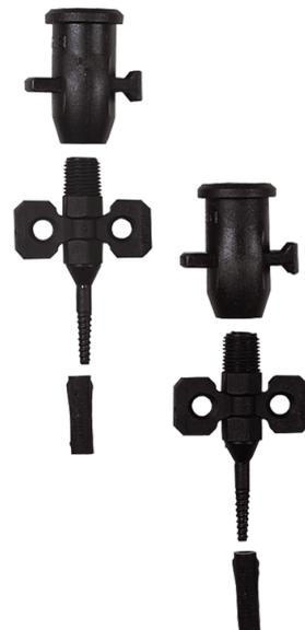
Sopro FliesenPacker: Werden in die Bohrlöcher eingedreht. Sie sind seitlich geöffnet und ermöglichen das Verfüllen von Hohlräumen und Hohllagen von verschiedenen Baustoffen durch das Verpressen von Soprodur®-MicroHohlraumSchlämme im Niederdruckverfahren. Einsatzbereich: für Bohrlöcher mit einem Durchmesser von 6 und 8 mm.
