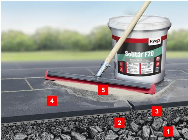
Aufbau Sopro Solitär®-System: 1. Verdichtete Schotterschicht; 2. Filterstabiler Edelsplitt; 3. Fliesenkleber, z. B. Sopro's No.1, rückseitig aufgezehnt im Buttering Verfahren; 4. Keramische Outdoorplatten mit einer Stärke  $\geq$  2 cm (Bitte die Formatbeschränkung beachten); 5. Fugenmörtel Sopro Solitär® F20
