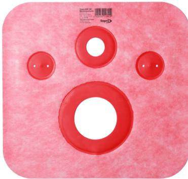
Innovative, beidseitig mit einem speziellen Vliesgewebe beschichtete Spezial-Wandmanschette zum sicheren Abdichten der Rohrdurchführungen von WC-Anlagen. Mit der Sopro AEB® WC Wandmanschette lassen sich die Rohrdurchdringung des Wasserzuflusses, die Rohrdurchdringung des Abwasserrohres sowie die beiden Gewindebolzen der Toilettenhalterungen gleichzeitig abdichten.
