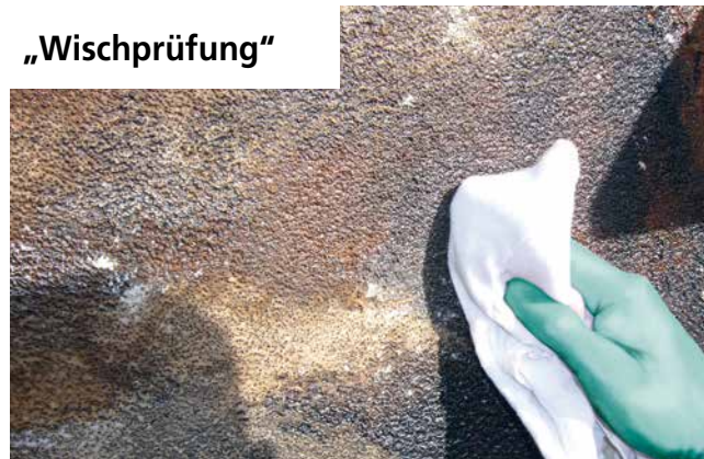
Wischprüfung mit weißem Tuch und Benzin.
