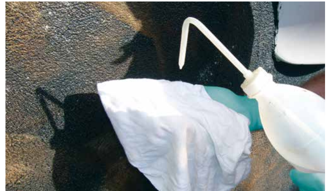
Wischprüfung mit weißem Tuch und Benzin.
