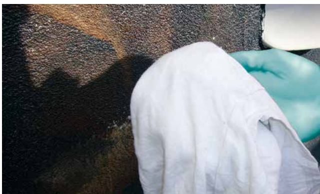
Keine Färbung: Ein Anlösen des alten Anstriches hat sich nicht gezeigt. Es handelt sich mit hoher Sicherheit um einen Teerpechanstrich.
