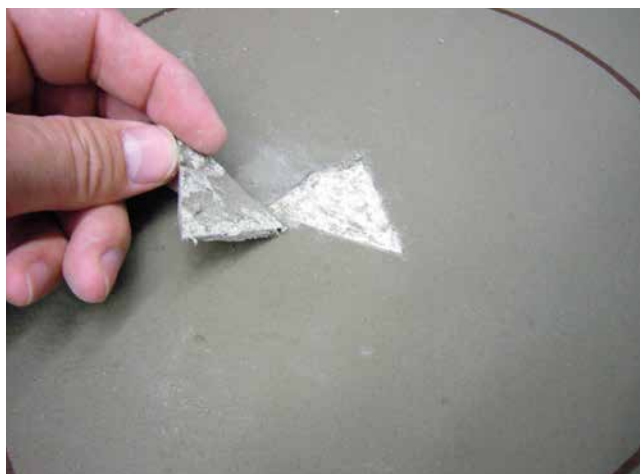
Herausgeschnittenes Abdichtungsstück zur Ermittlung der Schichtdicke.
