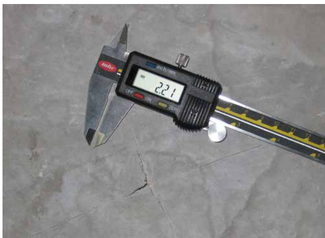
Schieblehre zum Messen der Schichtdicke.
