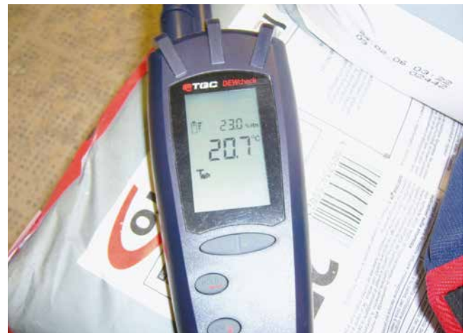
Messung der Lufttemperatur und der relativen Luftfeuchte.
