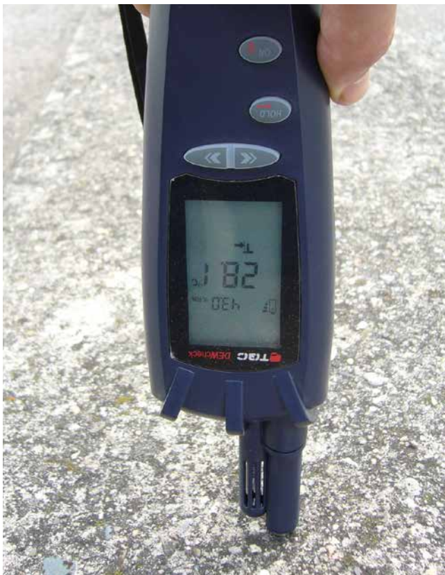
Messung der Bauteiltemperatur.
