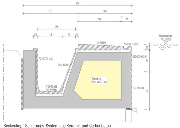
Beckenkopf-Sanierungs-System aus Keramik und Carbonbeton
