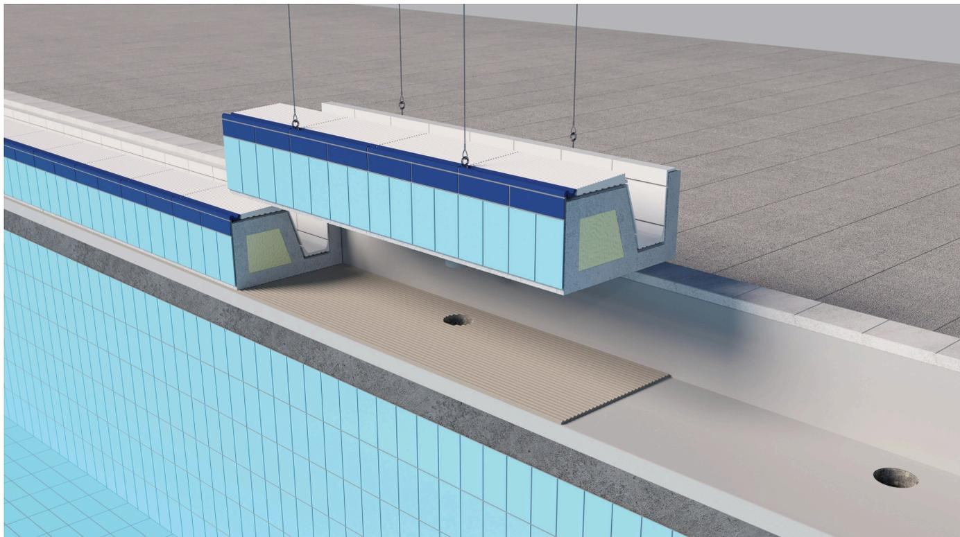
AGROB BUCHTAL hat in Zusammenarbeit mit CARBOCON eine neue Lösung zur Sanierung von Beckenköpfen entwickelt: ein mit Fliesen vorgefertigter Beckenkopf mit einem Kern aus carbonbewehrtem Beton. Die Fertigbauteile ermöglichen zeitsparende Bauabläufe und ressourceneffiziente Lösungen.
