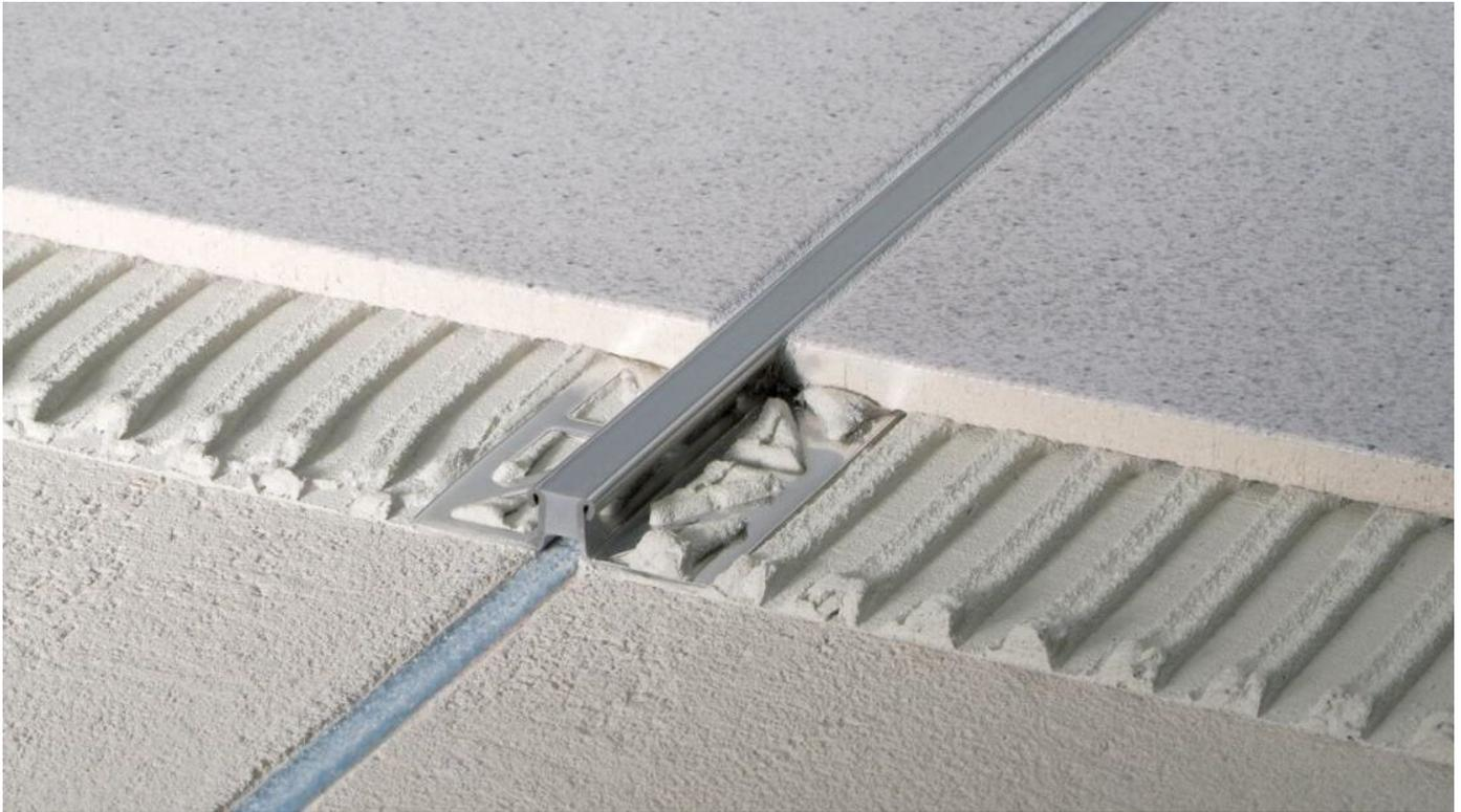
Blanke Bewegungsprofile werden dort verlegt, wo der Boden starkem Druck, Zug oder hohen Scherspannungen ausgesetzt ist. Diese Dehnungsfugen schützen Fliesen, Klinker, Kunst- und Natursteinplatten vor Rissen und verhindern bei Estrich den Trittschallübertrag.
