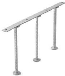
Die JORDAHL® Schubbewehrung JDA-S wird unter anderem in Unterzügen und Tunneln verwendet. Sie besteht aus Doppelkopfkankern, die durch eine Leiste verbunden sind. Es garantiert eine optimale Kraftübertragung mit geringen Verformungen im Bereich hochbelastbarer Auflager. Die JORDAHL® Schubbewehrung JDA-S stellt somit die ideale Ergänzung zur JORDAHL® Durchstanzbewehrung JDA dar.
