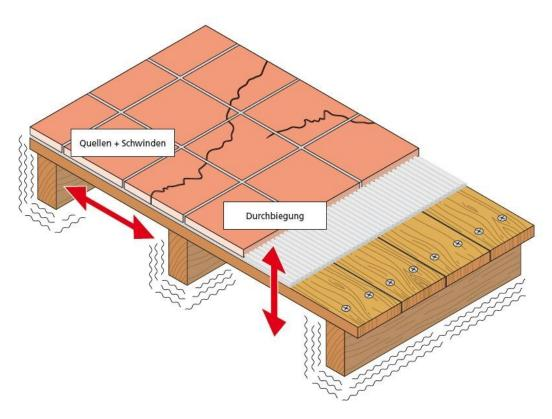
Die Sopro FliesenDämmPlatte ist eine Polyesterfaserdämmplatte, die in den Stärken 4 mm, 9 mm und 15 mm hergestellt wird. Sie kann zur Entkopplung, Wärmedämmung und auch zur Trittschalldämmung eingesetzt werden. Darüber hinaus verbessert sie die Biegefestigkeit der Gesamtkonstruktion.
