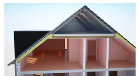
Heizwärmeverlust über ein ungedämmtes Dach
