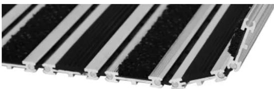
Die Basis der Eingangsmatte bilden 60 Millimeter breite, gerillte und dadurch rutschhemmende Aluminiumprofile. Deren Einlagen bestehen je nach Bedarf aus gezahnten PVC-Gummistreifen zur Aufnahme grober Verschmutzungen sowie Ableitung von Feuchtigkeit und aus wasserfesten Polyamidfaser-Textilstreifen zur Aufnahme feiner Verschmutzungen.
