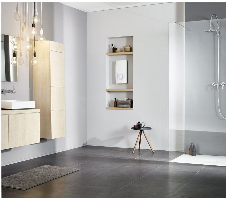
Bei den vollelektronischen Durchlauferhitzern verbindet sich hoher Komfort mit Energieeffizienz. So heizen diese Geräte direkt beim Durchströmen genau so viel Wasser auf, wie wirklich zum Baden oder Duschen benötigt wird – exakt auf die Wunschtemperatur. Die energiesparenden E-Komfort-Durchlauferhitzer DSX Touch und DEX Next eignen sich auch für die Einbindung in Solaranlagen.
